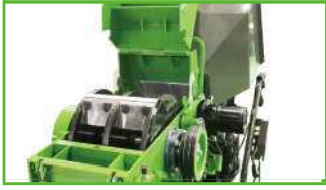
ロータ上部(ロータカバー)
