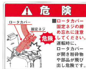
31 ロータカバー固定ネジ締め忘れ注意
