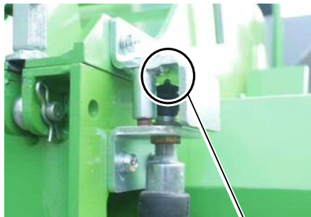
ロータカバー『閉』でセフティスイッチの先端が見えている状態
