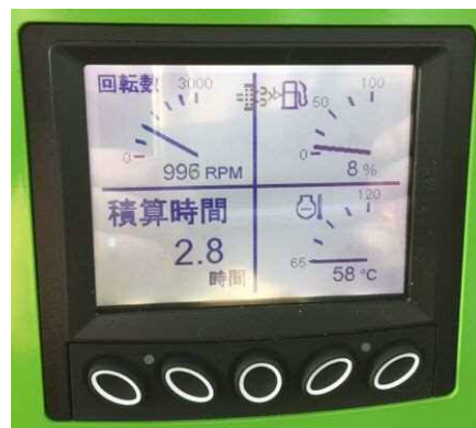
ボタン3を押すと上の画面に変わり、回転数が上がり、再生を開始します。
